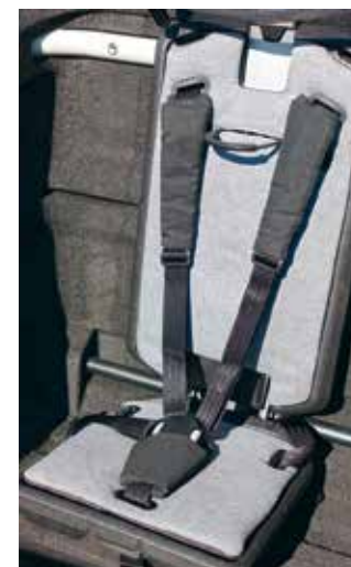
Die Passagiere werden mit Fünf-Punkt-Gurt und Kopfstützen am Sitz gesichert (links). Die Automatikschaltung (rechts) kommt von Enviolo
