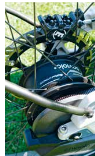
Die Passagiere werden mit Fünf-Punkt-Gurt und Kopfstützen am Sitz gesichert (links). Die Automatikschaltung (rechts) kommt von Enviolo
