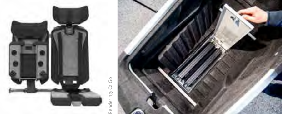
Klappbare und gefederte Kindersitze mit Kopfstützen; (Dual)Akku-Fach im Fußraum.
