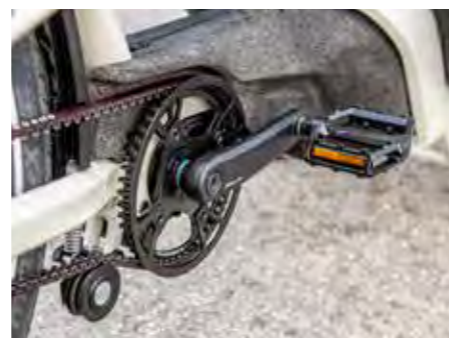
Der Gates Riemenantrieb mit automatischer Spannrolle erspart das häufige Prüfen und Nachspannen des Riemens.
