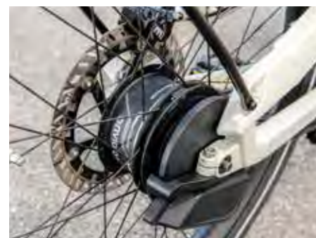
Top-Ausstattung: Enviolo Automatikschaltung, große 220 mm Bremsscheibe, Ca Go Riemen-Führung gegen Überspringen.
