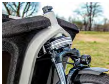
Genial: Die Seilzugsteuerung (hier noch ohne Abdeckung) mit spezieller Übersetzung macht das Ca Go agil und sicher.
