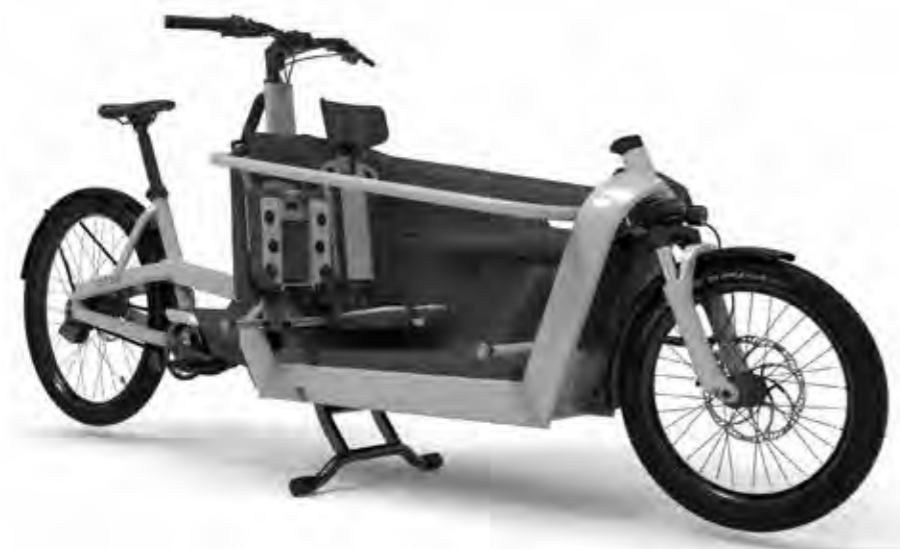
Der Aufschnitt macht deutlich: Der rundum verlaufende Rahmen schützt im Ernstfall die Insassen oder das jeweilige Transportgut.
