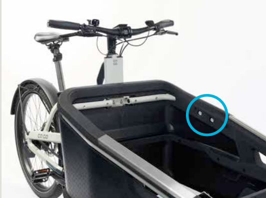
Vorgeformte Bohrlöcher an der Seite der Box
